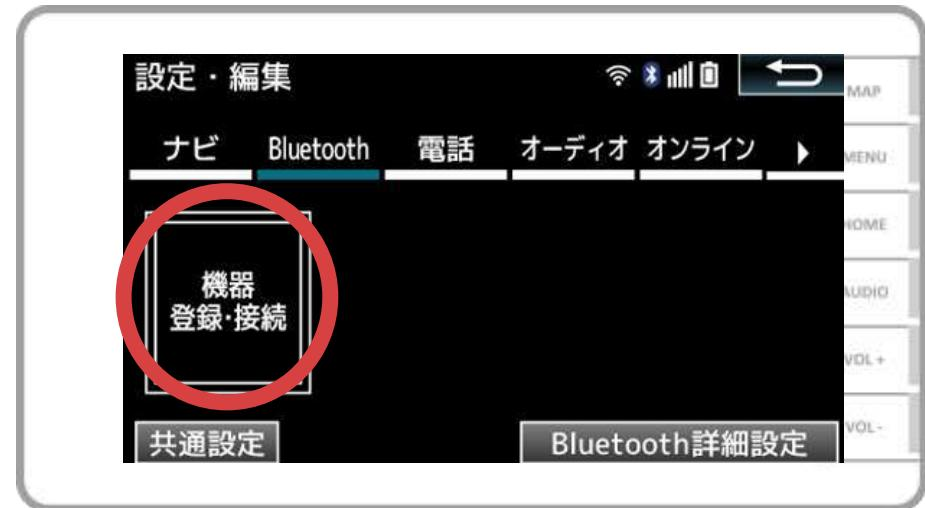
カーナビの画面で、「MENU」→「設定・編集」→「Bluetooth」→「機器登録・接続」の順に操作してBluetoothの機器登録の画面を表示します。
