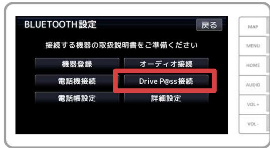
カーナビの画面で「ツートップメニューマーク」→「設定」→「Bluetooth設定」→「DriveP@ss接続」→「NaviCon」の順に操作し、リストから「NaviCon」を起動したスマートフォンを選択します。
