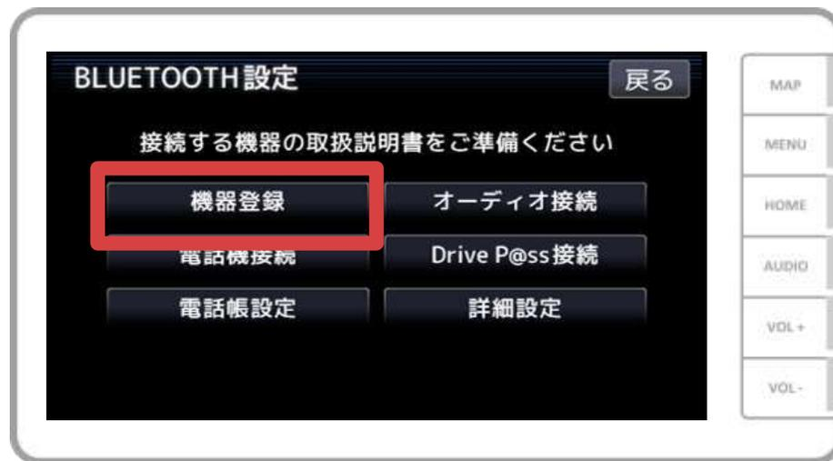
カーナビの画面で「ツートップメニューマーク」→「設定」→「Bluetooth設定」→「機器登録」→「新規登録」の順に操作してBluetoothの機器登録の画面を表示します。
