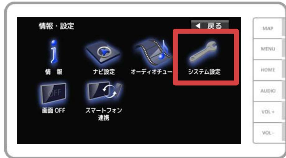
カーナビの画面で「MENU」→「情報・設定」→「システム設定」→「BLUETOOTH」→「機器登録」→「ハンズフリー」の順に操作してBluetoothの機器登録の画面を表示します。
