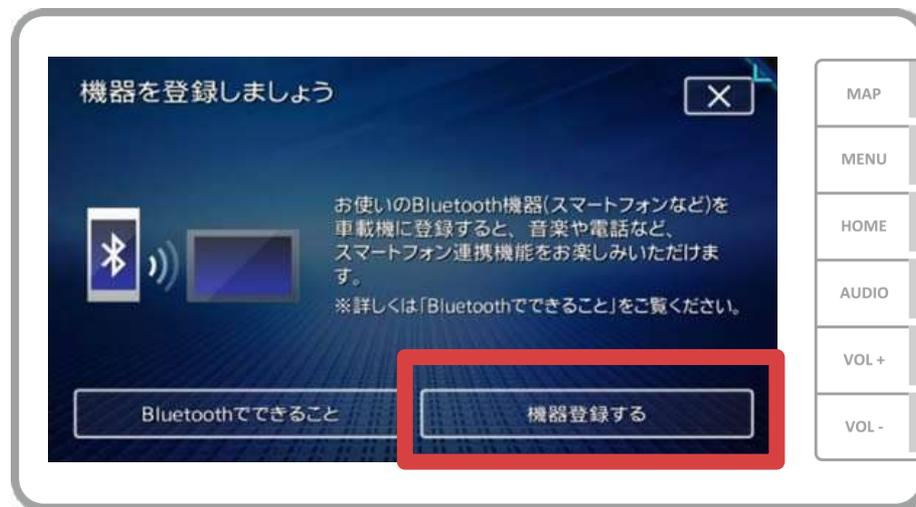
カーナビの画面で、「メニュー」→「設定」→「Bluetooth設定」→「機器登録」→「機器登録する」の順に操作してBluetoothの機器登録の画面を表示します。
