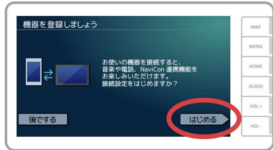
カーナビの画面で、「メニュー」→「情報・設定」→「システム設定」→「Bluetooth」→「機器登録」→「はじめる」の順に操作してBluetooth設定画面を表示します。
