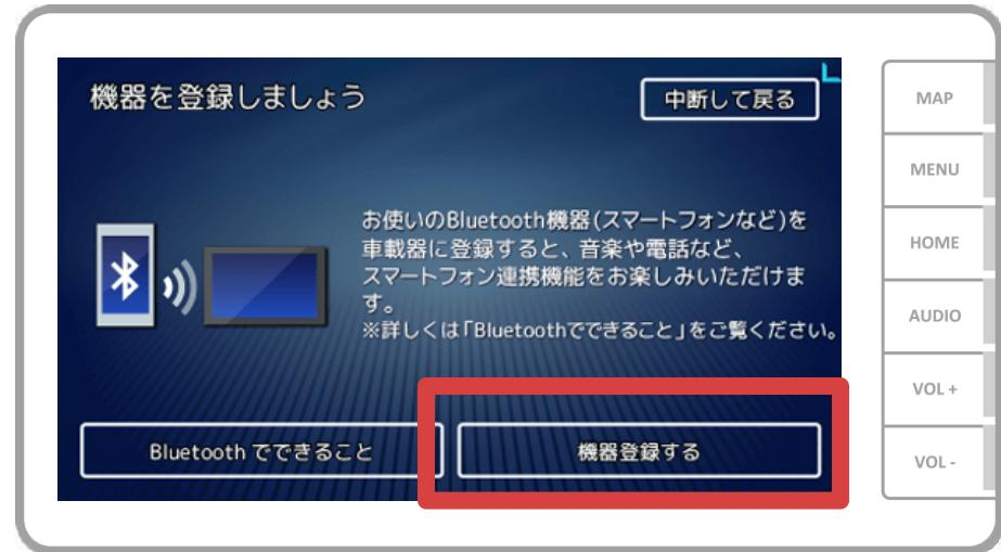
カーナビの画面で、「メニュー」→ツールエリア( )の「設定」→「Bluetooth設定」→「機器登録」→「機器登録する」の順に操作してBluetoothの機器登録を開始します。
