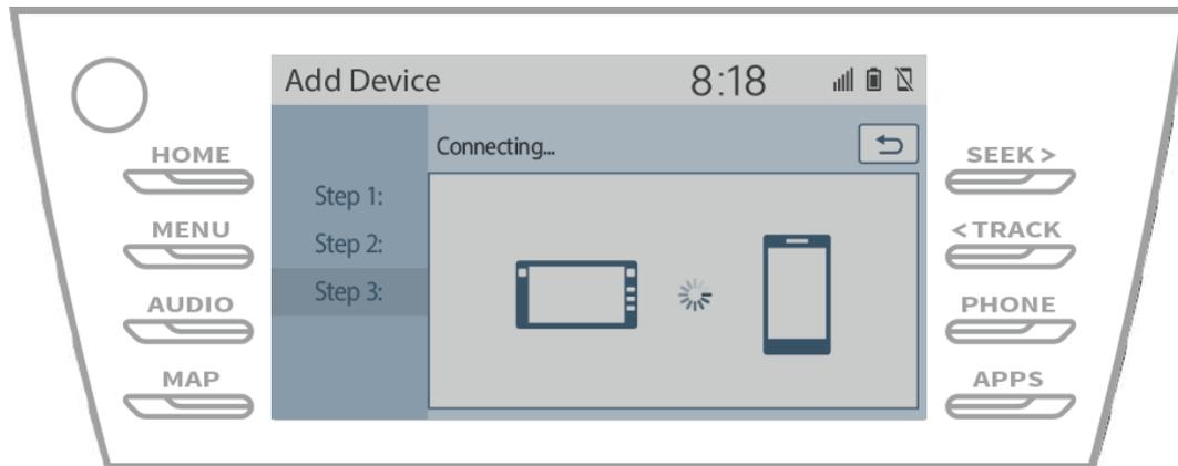
检查显示在下面的屏幕，显示配对成功
